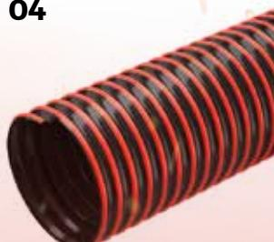
Tubo flessibile in gomma termoplastica TPV di colore nero e riga identificativa rossa, con spirale di rinforzo in acciaio incorporata tra i 2 strati. Il materiale è antifiamma, secondo la normativa UL 94 VO. Leggero e flessibile, presenta una notevole resistenza alle alte temperature, alle sostanze chimiche e all'abrasione. Può essere reso conduttivo ( $R<10^2$  Ohm/m) mettendo a terra la spirale.
