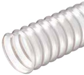
Tubo translúcido de TPU a base de éter con espiral de refuerzo de acero recubierta de TPU de color cobre. Material de pared antiestático permanente ( $R<10^9$  Ohm/m), resistente a los UV y a los ataques microbianos e hidrolíticos.
