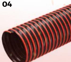
Tubo flexible de goma termoplástica TPV de color negro con banda de identificación roja, y espiral de refuerzo de acero incorporada entre las 2 capas. El material es resistente a las llamas según UL 94 V0. Ligero y flexible, tiene una resistencia considerable a las altas temperaturas, los productos químicos y la abrasión. Puede hacerse conductivo ( $R<10^2$  Ohm/m) conectando la espiral a tierra.
