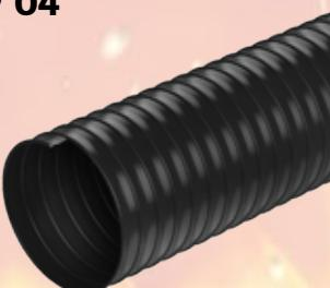
Tubo flexible de PVC-P de color negro con espiral de refuerzo de acero. Superficie interior y exterior ligeramente corrugada. La manguera es autoextinguible según UL 94 V0. Flexible, ligera, fácil de manejar, buen radio de curvatura.
