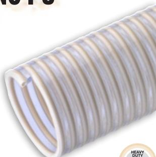
Tubo transparente de PVC-P, extracto interior en TPU a base de éter y espiral de refuerzo de PVC rígido antichoque y resistente al aplastamiento, de color marfil. Solución ideal para aspiración y transporte de polvo y líquidos alimentarios (con concentraciones alcoholísticas de hasta al 20%). Versión antiestática con hilo de cobre bajo demanda (cód. NR 02). Alimentario según Reg. UE 10/2011 (clases A, B, C, D2).
